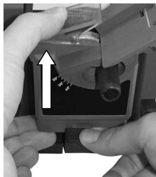
Hinweise: Entfernen Sie den verwendeten Adapter erst aus den Führungsschienen wenn der Schleifstein zum völligen Stillstand gekommen ist.
